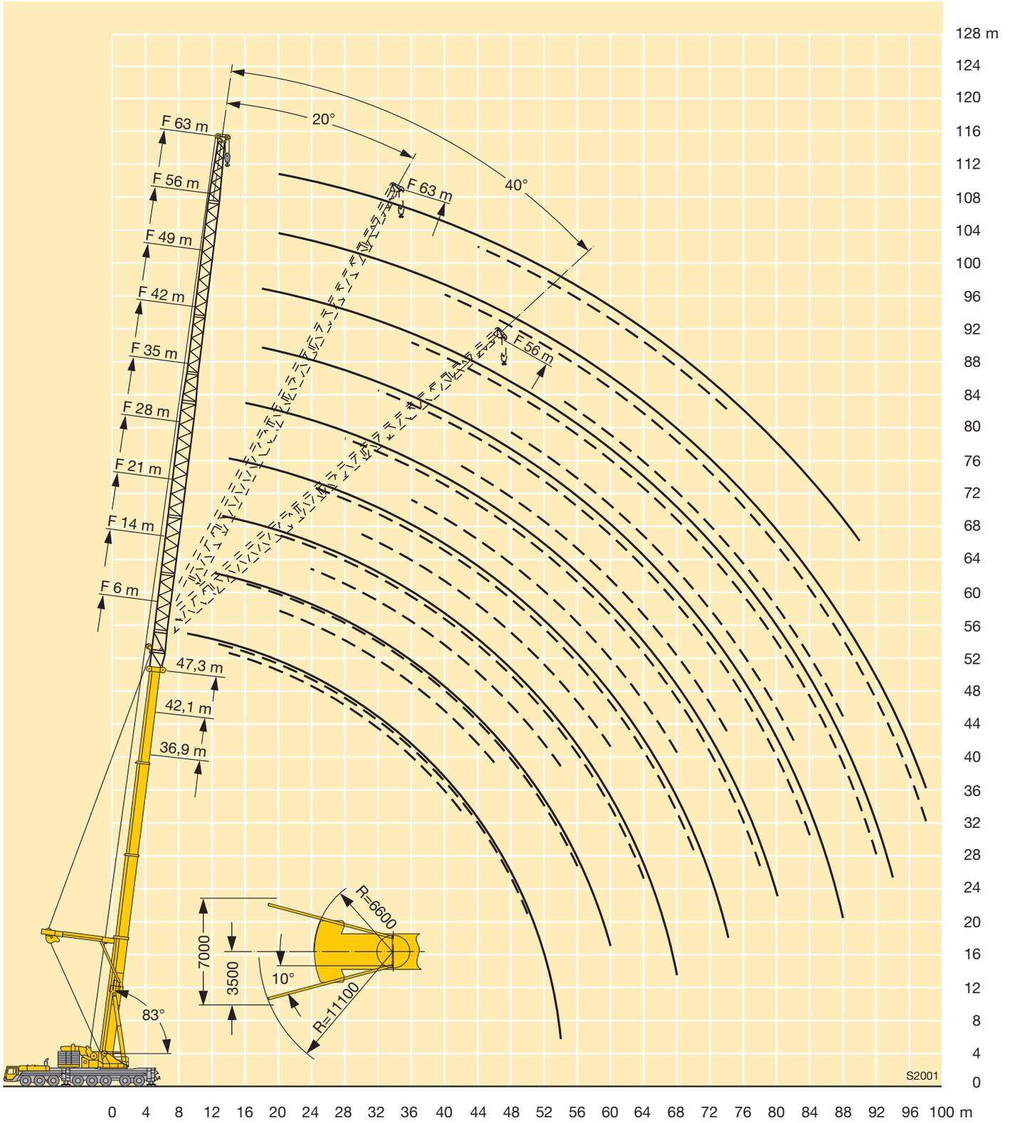
**Traglasten an der festen Gitterspitze mit abgespanntem Teleskopausleger und Exzenter**
