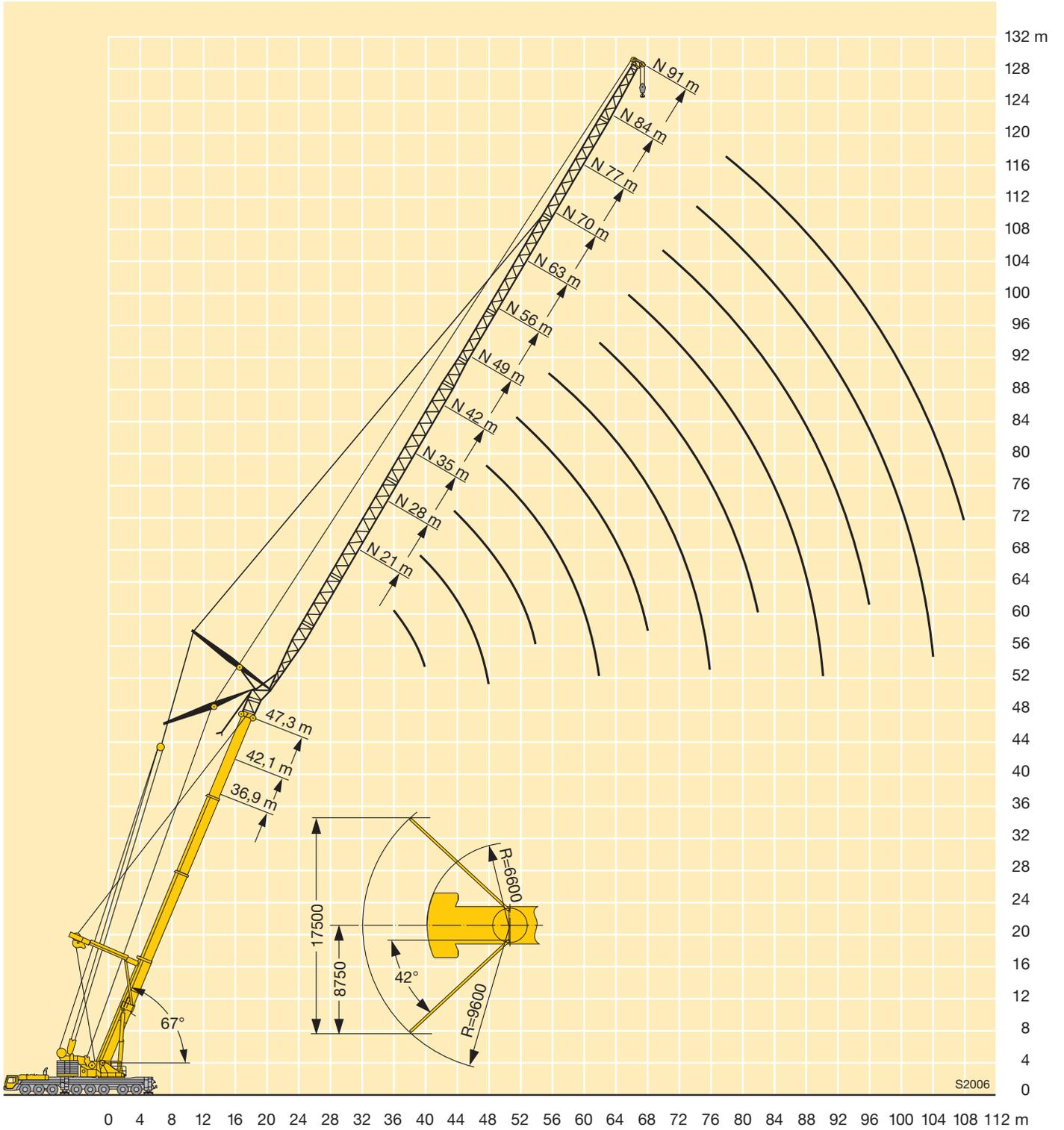
**Traglasten an der wippbaren Gitterspitze mit abgespanntem, verlängertem Teleskopausleger**
