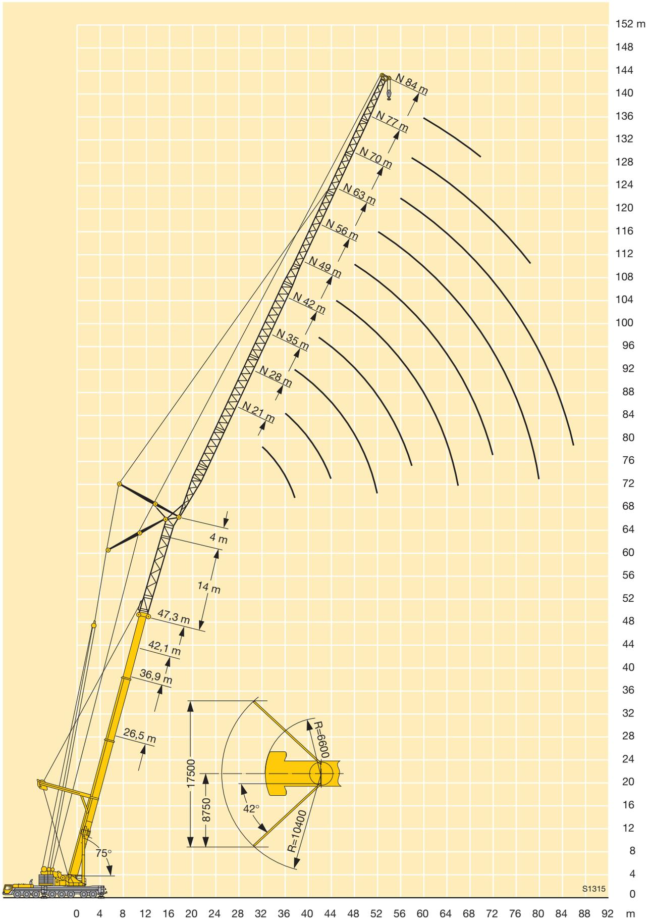
**Traglasten an der wippbaren Gitterspitze mit abgespanntem, verlängertem Teleskopausleger**
