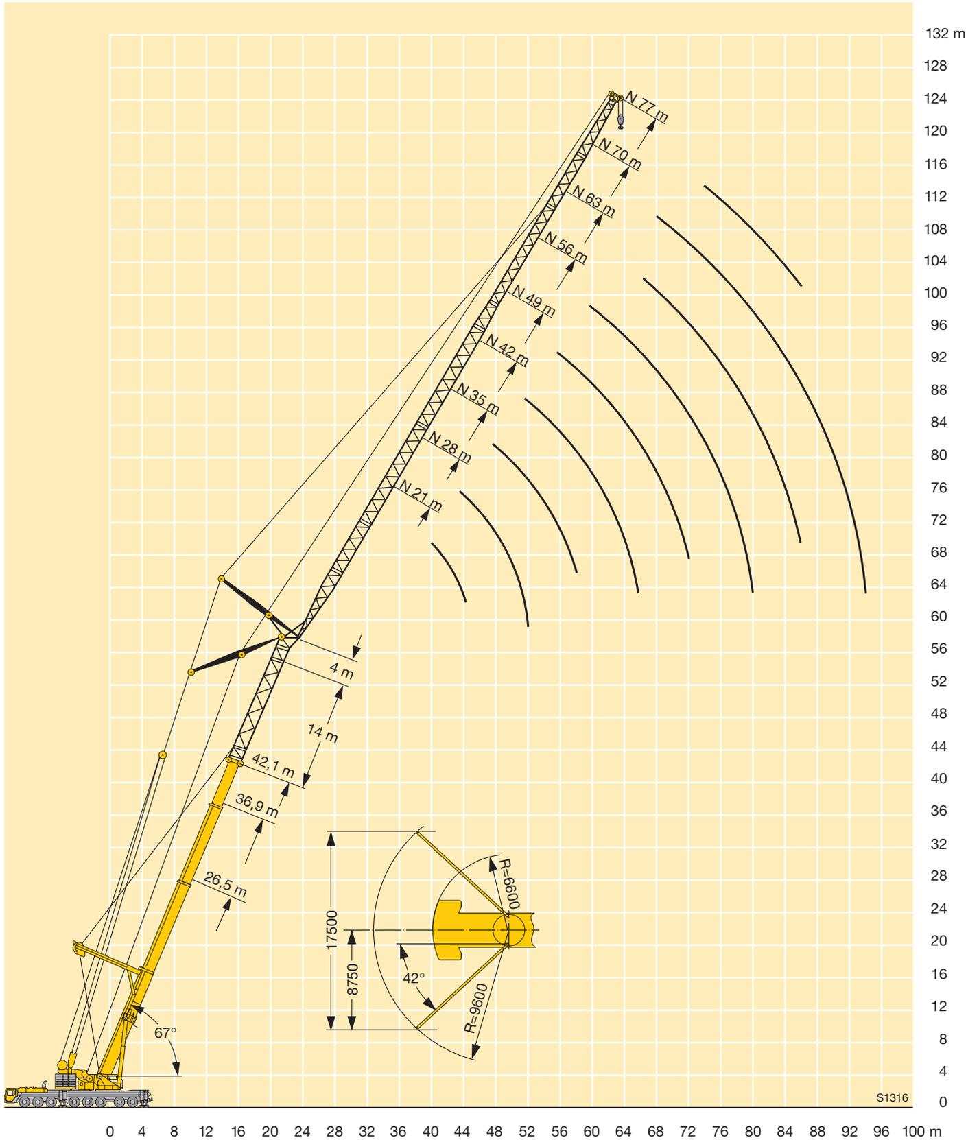
**Traglasten an der wippbaren Gitterspitze mit abgespanntem Teleskopausleger und Spacer**
